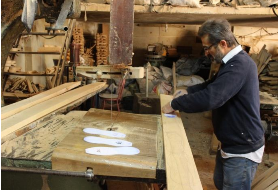
Fotoğraf 7: Ayak kalıbı tahtanın üzerine çizilirken
