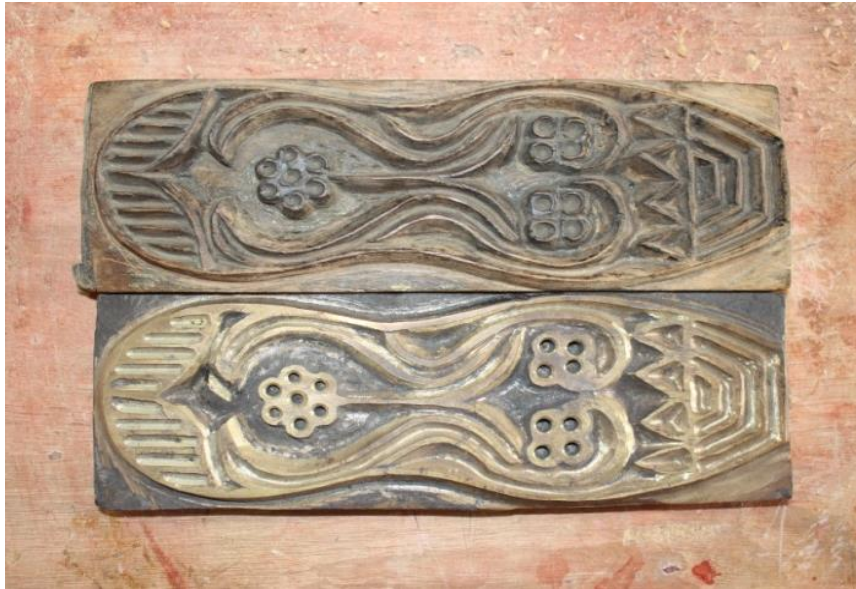
Fotoğraf 10: Takunyanın ağaçtan ve sarı, pirinç karışımından yapılmış desen kalıpları
