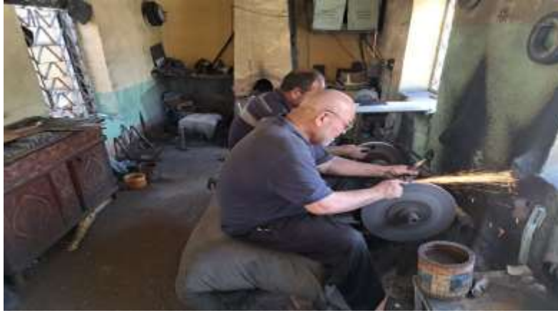
Fotoğraf 2: Arka tarafta demirin tavlama sırasında kullanılan ocak ve bıçağa zımparada şekil veren ustalar. (17.07.2024)
